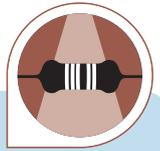
Los detectores en relé BWare™ incluyen triple Resistencia Final de Línea (RFL) eliminando la necesidad para los instaladores de añadir resistencias al detector, simplificando la instalación y ahorrando tiempo.
