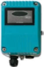
Detector de llama con doble tecnología sensores de infrarrojo (IR2) y ultravioletas (UV: 185 a 260 nm). Cono de detección de 90° y distancia de detección hasta 45 metros. Bajo consumo (8mA). Incorpora salida de relé. Sensibilidad programable. Incorpora filtros y análisis mediante microprocesador para eliminación de falsas alarmas. Respuesta espectral en el infrarrojo: 1 a 2,7um. Alimentación 14-28Vcc. Consumo: 20mA. Carcasa IP65 de aleación de zinc.
