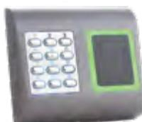
**ACL805SUW-RDMF-G** Lector de proximidad compatible con tecnologías de lectura Mifare Classic, Mifare Ultralight, Mifare Desfire con distancia de lectura de 1 a 3 cm con Teclado de aluminio para montaje en superficie compatible con protocolo Wiegand 26, 30, 34, 40, 42, 58 bit, con teclado metálico retroiluminado, leds de estado, zumbador, protección tamper, consumo 70mA, alimentación 9-14V DC, Distancia máxima del cableado entre el lector y el controlador hasta 50 metros.
