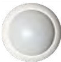
**DD669AM** Detector volumétrico de techo de doble tecnología con anticamuflaje: Infrarrojos (IR) y microondas (MW). Radio: 10 metros con 18 cortinas. Antimasking. Salidas: alarma (NC) y tamper (NC). Altura instalación: 2,5 a 5 metros. Campo de visión: 180° o 360°. Alimentación: 12Vcc. Temperatura de trabajo: -18°C a 55°C. Dimensiones: 138x66mm. Certificado Grado de Seguridad 3. Garantía de cinco años.
