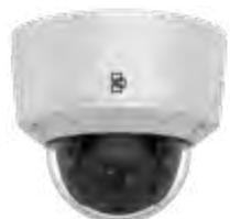
Cámara TruVision IP Domo con IR. Óptica varifocal motorizada de 2.8 a 12mm. Codificación H.265/H.264, Día/Noche Real. Led IR hasta 30m. WDR 120 dB, 1Entrada/1Salida de audio y alarma. Ranura tarjeta micro SD/SHDC/SDXC hasta 128 Gb. Compatibilidad ONVIF G y S. Alimentación POE (802.3-af) /12VCC, IP67, IK10.
