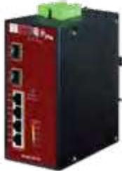
**MC352-4P-2S** Conversor de Medios Gigabit Ethernet No Gestionable de 4-Puertos PoE de cobre 10/100/1000 Base-Tx IEEE802.3af (4x30W) + 2-Puertos SFP. Alimentación redundante 12 a 48Vcc. Cumple IEEE802.3 e IEC60068-2-xx caída libre, choque y vibración. Montaje en carril DIN o en pared. Acepta Fast Ethernet SFP 100Base-SX/FX/BX/LX y Gigabit Ethernet 1000Base-SX/BX/LX/LHX/ZX.
