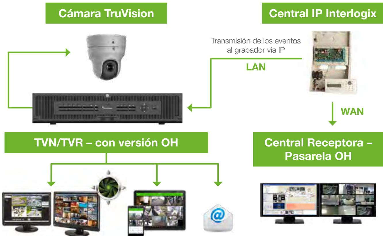
**Posibles acciones:** Activación de la grabación de alarma (1 evento = +/- 10 segundos de grabación sobre Flujo principal) • **Activación del zumbador** del grabador • **PTZ:** ejecución de Presets, rondas Shadow o secuencia de PRESETS • **Activación** de la salida relé del grabador • **TVRmobile** Push de las notificaciones del grabador a teléfonos inteligentes mediante la aplicación TVRmobile (iOS y Android).
