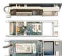
**ZW-7000** El módulo añade conexión móvil 3G a la central ZeroWire, permitiendo la transmisión de alarmas y la conexión remota por red móvil 3G a través de la nube UltraSync. Tarjeta SIM opcional. ZW-7001 disponible con tarjeta SIM Global UltraSync. Consultar. El módulo se instala en el interior del panel, e incluye la antena. Certificado EN50131-10 y EN50131-6 Grado 2 Clase II. **190,48 €**
