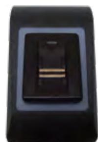
**ACL800SUW-BS-B** Lector de huella con barra de escáner estático que precisa el desplazamiento completo de la huella, para montaje en superficie incluye zumbador y led de tres colores para indicar el estado (acceso concedido, acceso denegado o inactivo). Hasta 100 huellas. Salida Wiegand 26 a 80 bits. Salida de relé NO/NC. Alimentación 9 a 14 VDC. Protección: IP65. Distancia máxima de 50 metros. Compatible con módulo ACL800FL-RU2-W.
