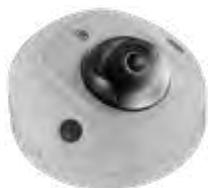
Minidomo TruVision IP tipo Wedge con IR. Óptica 2.0mm. Codificación H.265/H.264, Día/Noche real. Led IR de 10 metros con filtro motorizado y WDR 120 dB. 1E/1S de alarma y 2E/1S de audio con micro integrado. Ranura tarjetas micro SD/SHDC/SDXC. Compatibilidad ONVIF G y S. Alimentación PoE (802.3-af) / 12 VCC, IP66, IK8.
