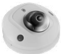
Minidomo TruVision IP tipo Wedge con IR. Óptica 2.8mm. Codificación H.265/H.264, Día/Noche real. Led IR de 10 metros con filtro motorizado y WDR 120 dB. 1E/1S de alarma y 2E/1S de audio con micro integrado. Ranura tarjetas micro SD/SHDC/SDXC. Compatibilidad ONVIF G y S. Alimentación PoE (802.3-af) / 12 VCC, IP66, IK8.
