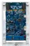
**ATS1236** Módulo receptor con 32 zonas vía radio más 2 zonas cableadas y una salida de relé programable para centrales Advisor Advanced, totalmente supervisadas. Conexión en bus. Frecuencia 433Mhz (Legacy\*, 63-bit y protocolo LoNa\*). Temperatura de trabajo de -10°C a 55°C. Alimentación a 12Vcc. Dimensiones: 155x95x26mm. Certificado Grado de Seguridad 2. **136,70 €**
