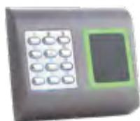
**ACL805SUW-RDPX-G** Lector de proximidad EM/CASI/HID 125kHz (EM4102, GE ProxLite/CASI Prox, HID Prox) con Teclado de aluminio para montaje en superficie compatible con protocolo Wiegand 26, 30, 34, 40, 42, 58 bit, con teclado metálico retroiluminado, leds de estado, zumbador, protección tamper, consumo 70mA, alimentación 9-14V DC, Distancia máxima del cableado entre el lector y el controlador hasta 50 metros.
