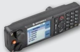
**CABEZAL DE CONTROL IP67**
