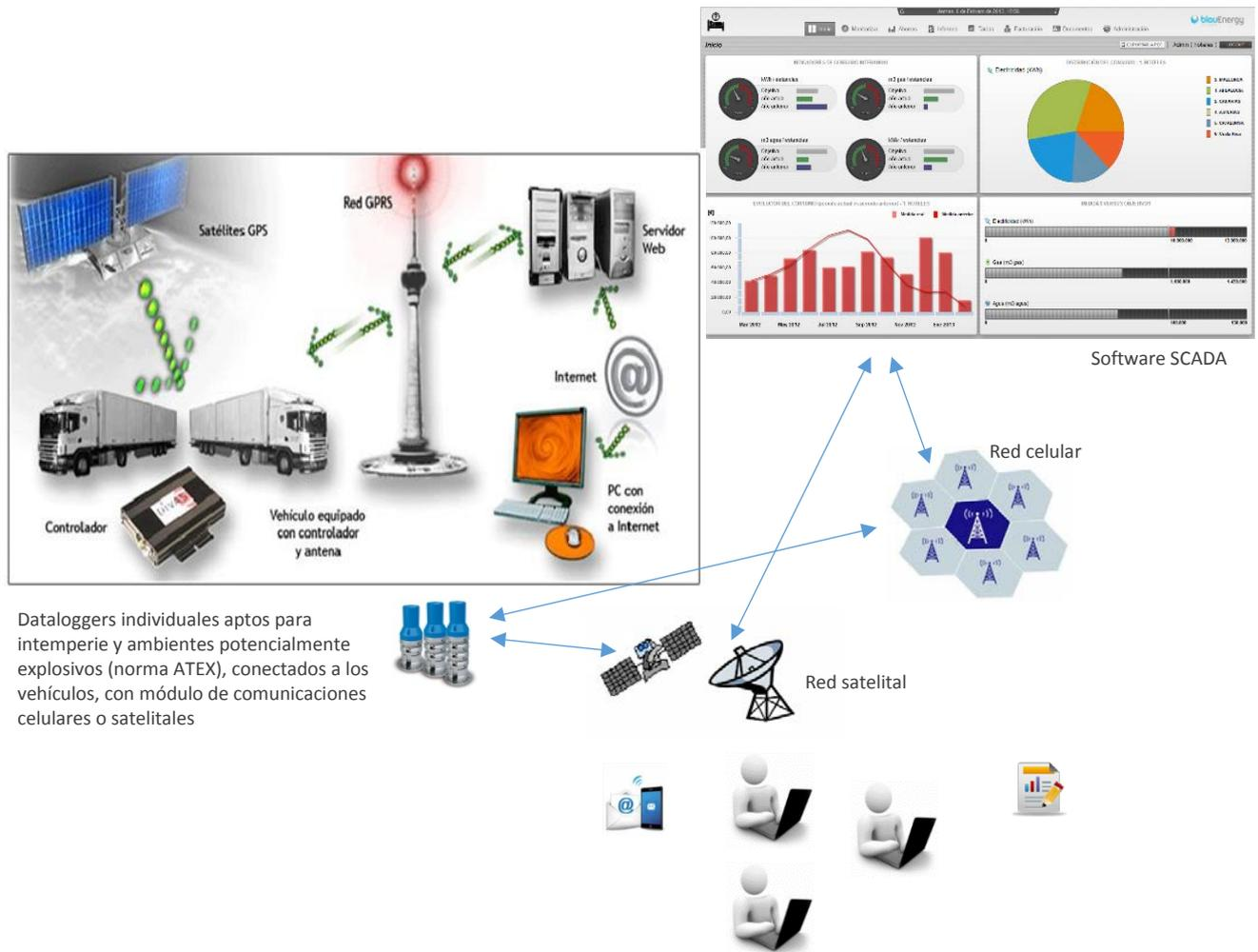
Dataloggers individuales aptos para intemperie y ambientes potencialmente explosivos (norma ATEX), conectados a los vehículos, con módulo de comunicaciones celulares o satelitales
