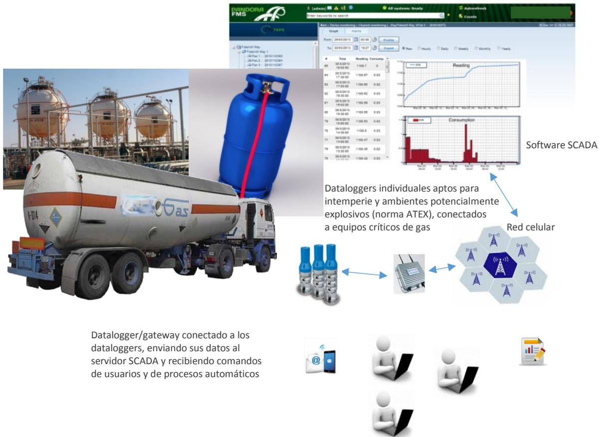
La solución consiste en instalar dataloggers certificados para ambientes explosivos y bajo normas ATEX. Estas unidades remotas son capaces de tele-medir datos críticos y actuar sobre dispositivos en base a comandos de usuarios. Además, los dataloggers se conectan a concentradores/gateways los cuales se comunican con el servidor SCADA.
